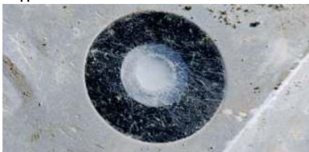
Царапины на стекле светодиода, приводящие к снижению яркости подсветки
