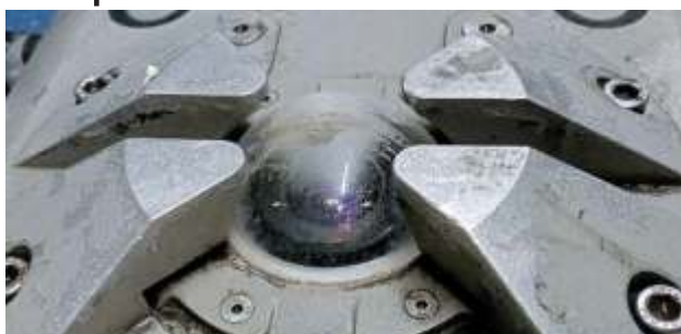
Царапины на защитном куполе камеры, приводящие к снижению качества изображения
