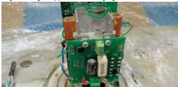
Электрохимическая коррозия при повреждении платформы
